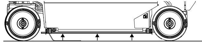
Plošina zcela spuštěná - tyče ochrany proti překlopení zvednuté
