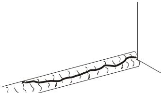
Trhlina ve svaru
